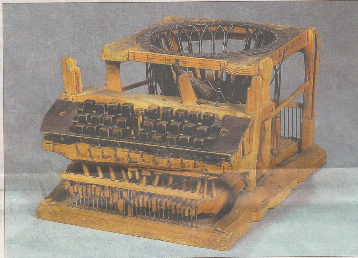
Das Schreibmaschinen-Modell von 1864 ist überwiegend aus Holz. Der Tischler Peter Mitterhofer aus dem Weiler Partschins/Südtirol hatte es „geschnitzt“.
